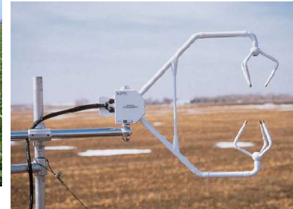
Medidor de velocidad de viento en 3D relacionado con el transporte turbulento de calor y humedad en la atmósfera
