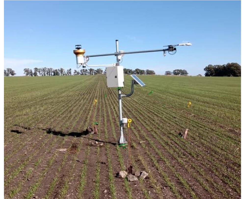
Mediciones in situ, cada 10-15 minutos, en una estación de balance de energía (EBE). Detalle de los sensores en https://digital.cic.gba.gob.ar/handle/11746/10710
