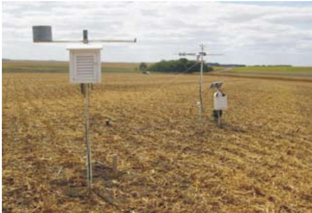
Figura 3. Estación meteorológica (delante) y Estación de balance de energía (detrás) instaladas sobre un rastrojo de soja.
